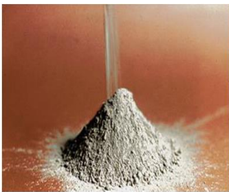
۲ شکل: د سېمنټو کلنکر له ژرنده کېدو څخه وروسته
