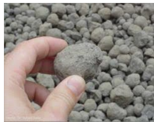
۱ شکل: د سېمنټو کلنکر له ژرنده کېدو څخه مخکې
