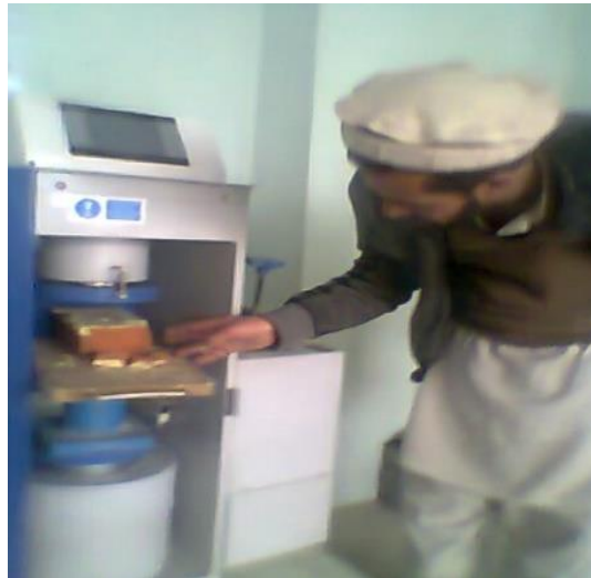
شکل ۲ : د جيو ساینټفیک په لابراتوار کې د خوست ولايت پخې خښتې د فشاري مقاومت د ازموينې پر مهال:
